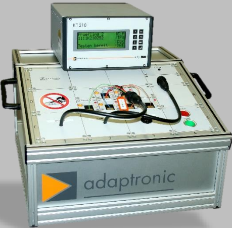
Prüfpult PT 40 mit Verdrahtungstester KT 210
