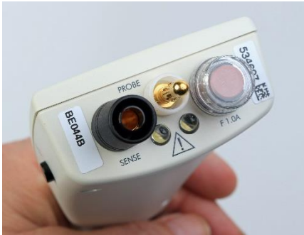
Seitlicher Taster und 2 Leuchtdioden an der Stirnseite zur Beleuchtung des Arbeitsbereichs
