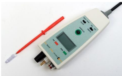
Seitlicher Taster und 2 Leuchtdioden an der Stirnseite zur Beleuchtung des Arbeitsbereichs
