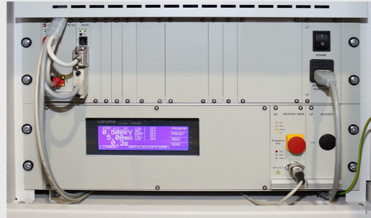
Integriertes NT 700-11: CPU-Einheit und HV-Generator
