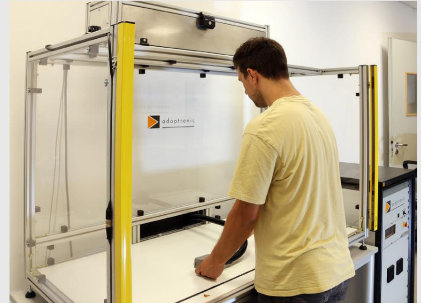
Die Sicherheitsprüfzelle lässt sich dank standardisierten Schnittstellen einfach in den Sicherheitskreis eines adaptronic Testgeräts integrieren. Die Sicherheitsprüfzelle hat hierfür ein Sicherheitsrelais verbaut, welches beim Hineingreifen in die Prüfzelle die Testspannung des Testgeräts abschaltet.
